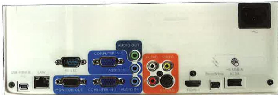
Als Besonderheiten sind bei den Anschlüssen die Mini-USB-Buchse für PointWrite sowie USB-Power zu nennen.
