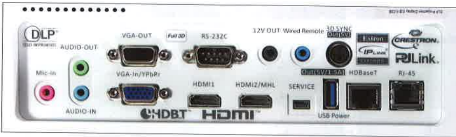
Das Anschlussfeld ist übrigens so beschriftet, dass es bei Über-Kopf-Montage lesbar ist.
