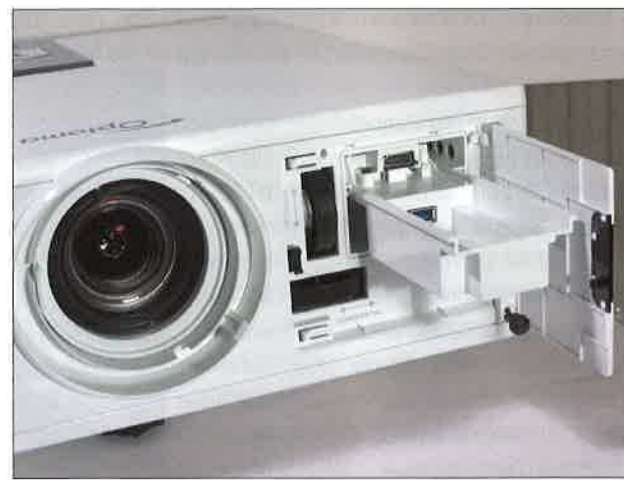
Rechts neben dem Objektiv verbergen sich die Stellräder für h+v Lens Shift sowie ein Fach für einen HDMI-Stick.
