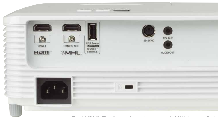
Zwei HDMI-Eingänge, davon ist einer mit MHL kompatibel, der Bildübertragung vom Smartphone, mit passendem Dongle geht das sogar drahtlos
